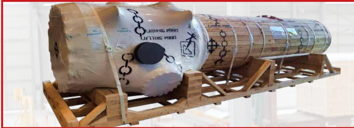
TURBINA CON FAJAS DE MADERA, RETRACTILADA Y PLATAFORMA
